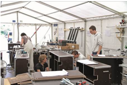
HECO_Université_de_Technologie de_Delft-Caissez_à_outils.jpg Cinq caisses à outils mobiles à tiroirs ont été conçues et fabriquées pour le stockage des matériaux nécessaires.
